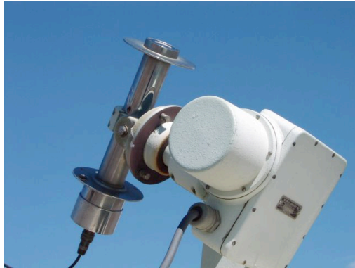
Figura 12: Piranómetros para la medición de la radiación directa e indirecta.
