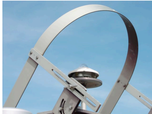
Figura 12: Piranómetros para la medición de la radiación directa e indirecta.
